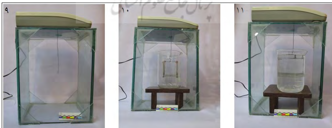
تصویر ۱۳. نحوه قرارگیری ترازو بر روی پایه نگه‌دارنده تا رسیدن به مرحله نهایی ساخت ترازوی هیدرو استاتیک آزمایشگاهی
