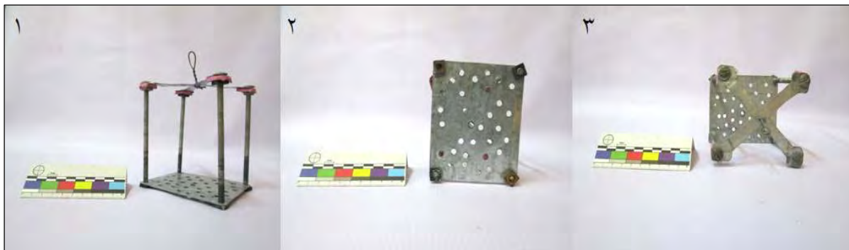
تصویر ۹. قفسه نگه‌دارنده نمونه به همراه جزئیات ساخته‌شده از جنس فلز، تصویر از سه نمای کلی قفسه
