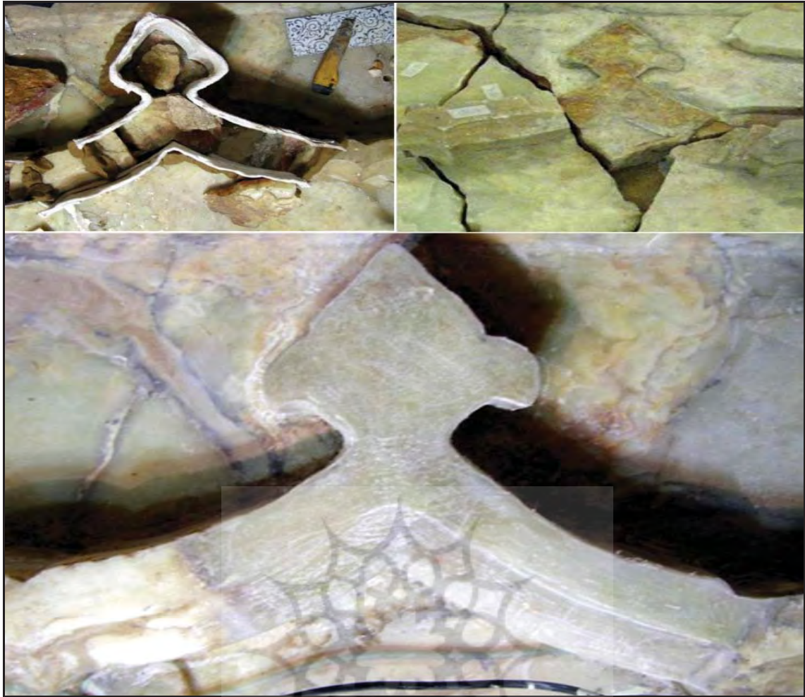
ت. ۱۴: قسمت‌های قالب گیری شده و ریخته گری شده بعد از عملیات تکمیلی به وسیله رزین پلی‌استر(ماخذ: نگارندگان)
