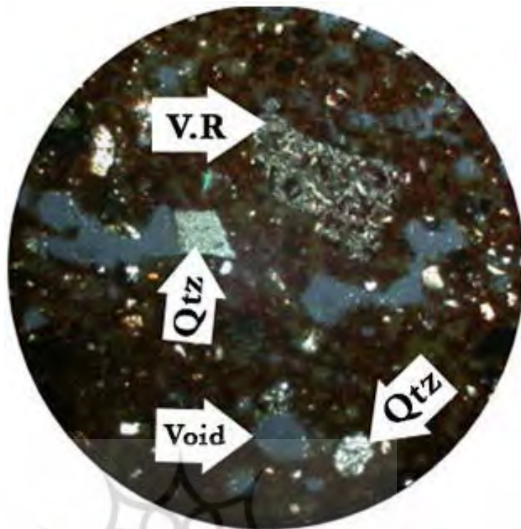
تصویر ۶. تصویر میکروسکوپی نمونه N5، بزرگنمایی 4X، نور XPL، بافت پورفیری، قطعات درشت سنگ آذرین و کوارتز به عنوان پرکننده یا خمیره در زمینه سفال دیده می‌شود (نگارندگان، ۱۳۹۸).
