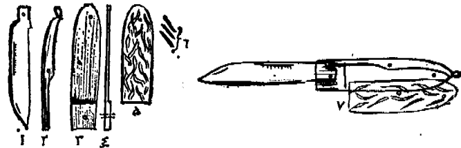
شکل ۲ اجزاء مرکب یک قبضه چاقوی قلمتراش یک تیغه ۱ - تیغه ۲ - فنر پشت ۳ و ۴ بار بند (آستر) ۵ - روپه ۶ - میخ‌ها (۳ عدد) ۷ - چاقو پس از سوار شدن قطعات
