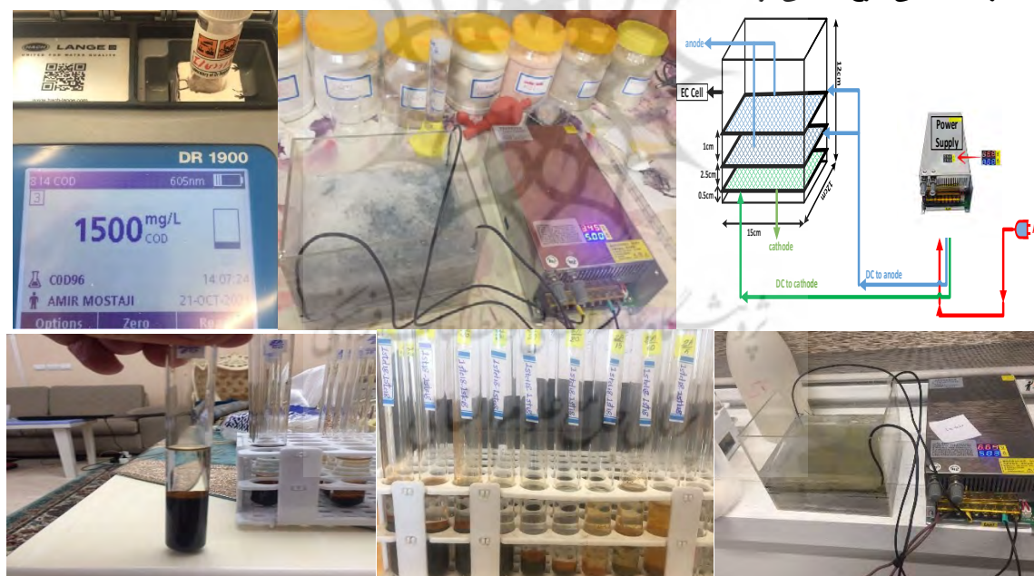
شکل ۱. سلول آزمایشی با آند و کاتد افقی برای فرآیند انعقاد الکتریکی.
