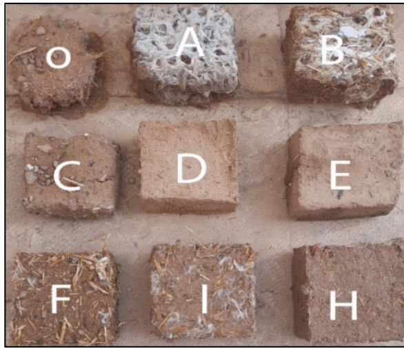
شکل ۱۰: نمونه‌ها بعد از انجام آزمایش آبشویی
