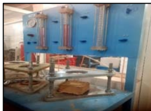
شکل ۱۷: آزمایش نفوذ پذیری نمونه D
