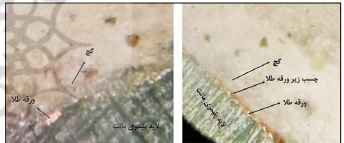
شکل ۳. بررسی مقطع لایه‌های کتیبه گچی برجسته از طریق میکروسکوپ نوری
