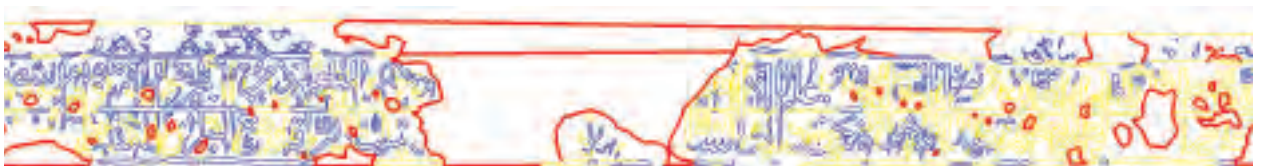
شکل ۲۳. طرح آسیب شناسی کتیبه گچبری جبهه غربی مسجد آق قلعه نقاب سبزوار (عکس از نگارنده)
