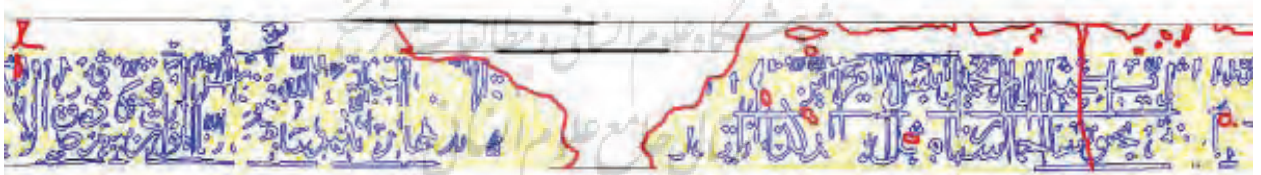
شکل ۲۱. طرح آسیب شناسی کتیبه گچبری جبهه شرقی مسجد آق قلعه نقاب سبزوار (عکس از نگارنده)
