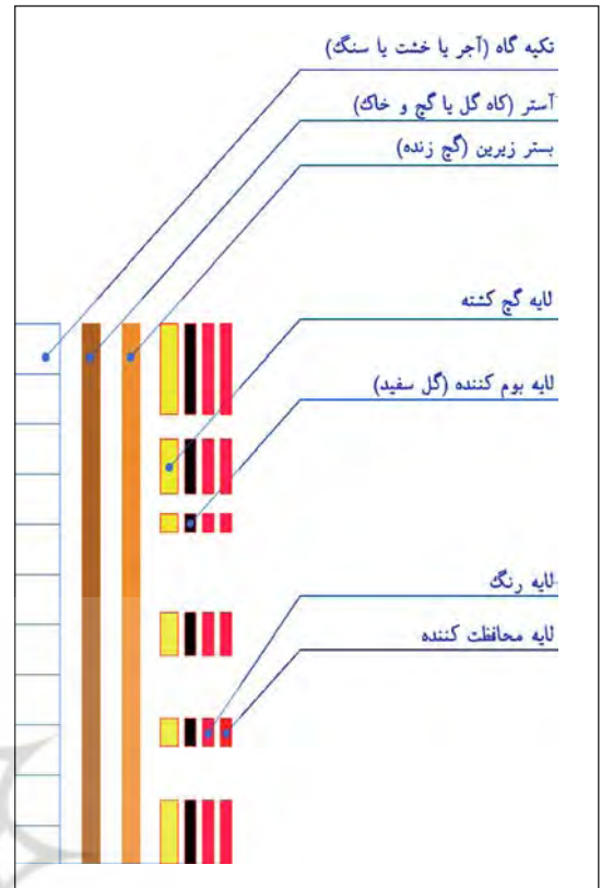
تصویر ۷. لایه‌های تشکیل‌دهنده آرایه گچی کشته‌بری بر اساس نظر نویسندگان دیگر از جمله آقاچانی اصفهانی
