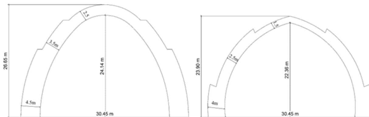
تصویر ۶. ابعاد دهانه، افراز و ضخامت مدل‌سازی شده طاق‌های آهنگ تیزه‌ندار و جناغی ارگ علی شاه. مأخذ: نگارندگان.
