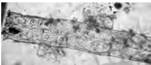
شکل ۷: انواع منفذهای موجود در الیاف کاغذ نقشه قالی مقوایی کرمان با بزرگ نمایی ۴۰۰x
