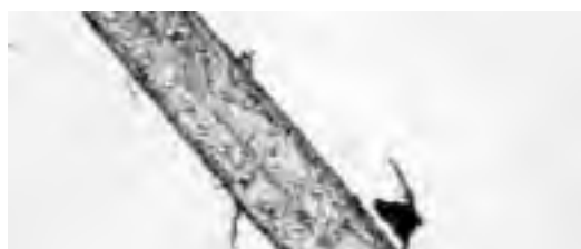
شکل ۵: انواع منفذهای موجود در الیاف کاغذ نقشه قالی بدون تکیه گاه کرمان با بزرگ نمایی ۴۰۰x
