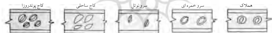
شکل ۲: انواع منقدها در پره‌های چوبی سوزنی برگان (۸)
