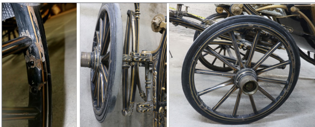
شکل ۹. آسیب‌های روی چرخ‌ها که به شکل ریختگی رنگ و گردو خاک دیده می‌شود.
