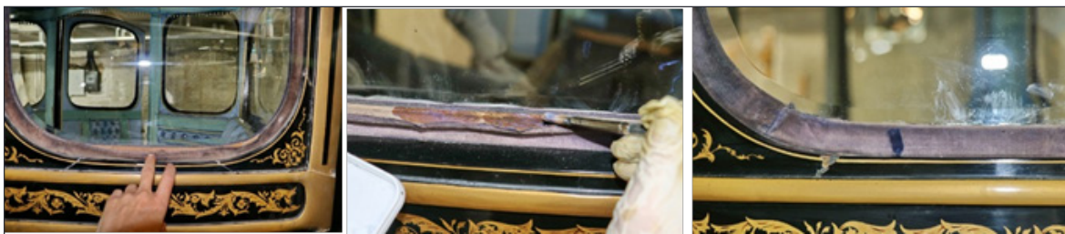
شکل ۱۶. پاکسازی و بازگرداندن نوارهای پارچه‌ای اطراف پنجره‌ها.
