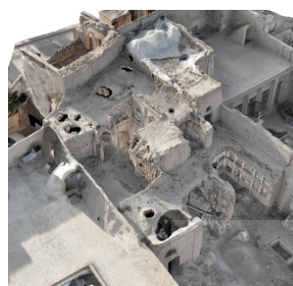
شکل ۱. مدل سه‌بعدی بنا با استفاده از فتوگرامتری برد کوتاه.
