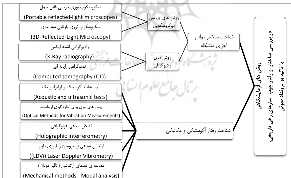
شکل ۱. نمودار معرفی اجمالی روش‌های آزمایشگاهی در بررسی ساختار و رفتار چوب سازهای زهی تاریخی
