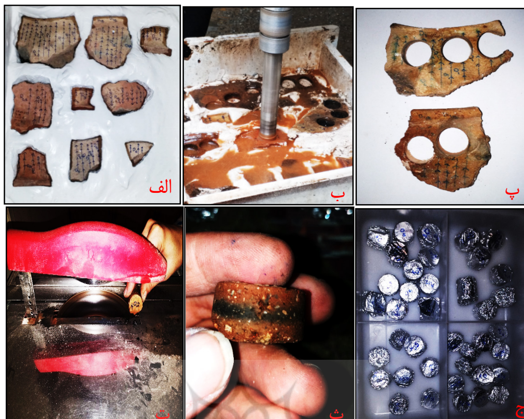
شکل ۴. مراحل آماده‌سازی نمونه‌ها جهت انجام آزمایش‌ها شامل: الف) تثبیت نمونه‌ها در گچ ب) مغزه‌گیری نمونه‌ها به قطر ۲/۵ سانتی‌متر پ) در آوردن بقایای نمونه‌ها جهت پودر کردن برای آنالیز کانی‌شناسی مغناطیسی ت) برش نمونه‌ها در اندازه‌های استاندارد ث) نمونه استاندارد جهت آنالیزهای مغناطیسی ج) پیچیدن فویل آلومینیومی بر به دور نمونه‌ها به منظور جلوگیری از گم شدن نمونه‌ها حین ترک خوردن در دستگاه مغناطیس‌سنجی حرارتی در اثر حرارت بالا است.
