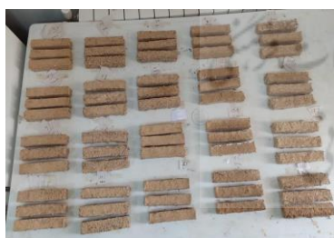
شکل ۲. نمونه‌های خشتی در محیط آزمایشگاه و قبل از انجام آزمون کشش
