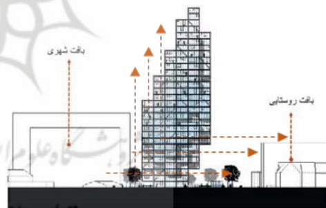
شکل ۲۱. پروژه اسکای ویلج - ساختار فضایی افقی - عمودی؛ در سمت بافت روستایی، ساختار عمدتاً افقی است، و در سمت بافت شهری، ساختار عمودی غالب است
