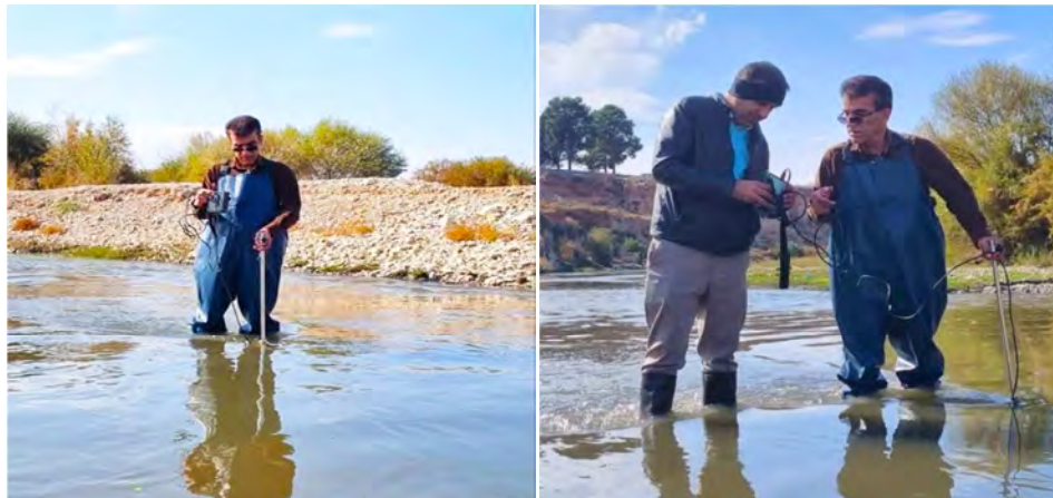
شکل ۴: نحوه اندازه‌گیری سرعت جریان در بازه مکانی مورد مطالعه
