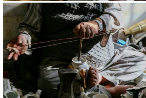
تصویر ۵. کمان؛ نحوه قرارگیری و سوراخ‌کاری (URL: 1).
