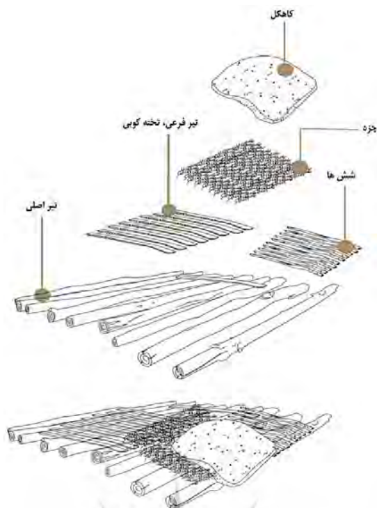
تصویر ۱۱: جزئیات نمونه‌ای از پوشش تخت در بام خانه‌های ابیانه (نویسندگان، ۱۴۰۲)
