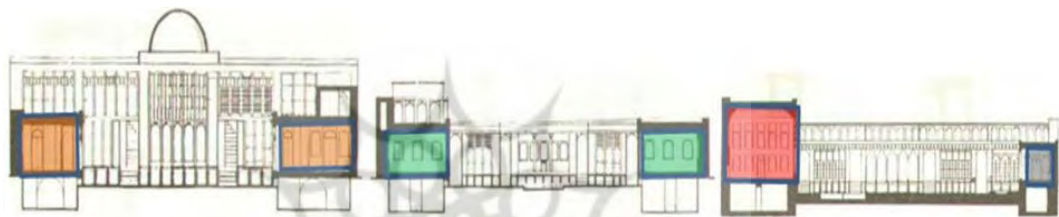
شکل ۷. نمایش تناسب ارتفاعی اتاق‌های خانه‌ی زینت الملک شیراز بر روی برش‌ها؛ شاه‌نشین: قرمز، پنج‌دري: نارنجی، سه‌دري: سبز و پستو: خاکستری (مؤمنی و ناصری، ۱۳۹۴)
