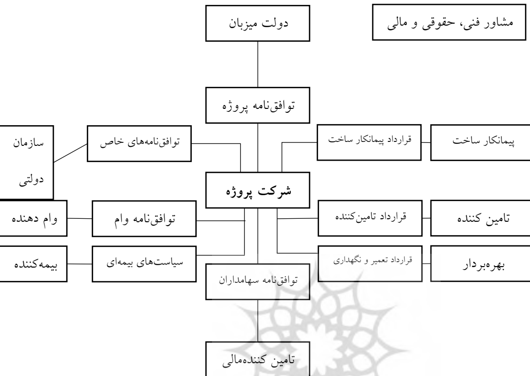
شکل (۲) - ساختار اجرای پروژه ها با مدل BOT (UNIDO, 1996)
