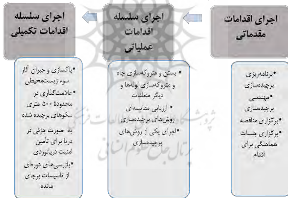
تصویر ۱. فرایند عملیات برچیده‌سازی تأسیسات فراساحلی متروکه
