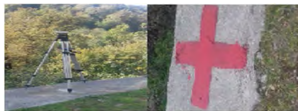
نگاره ۲: نقطه کنترل زمینی در عرصه (راست) و برداشت همان نقطه کنترل زمینی با DGPS (چپ)
