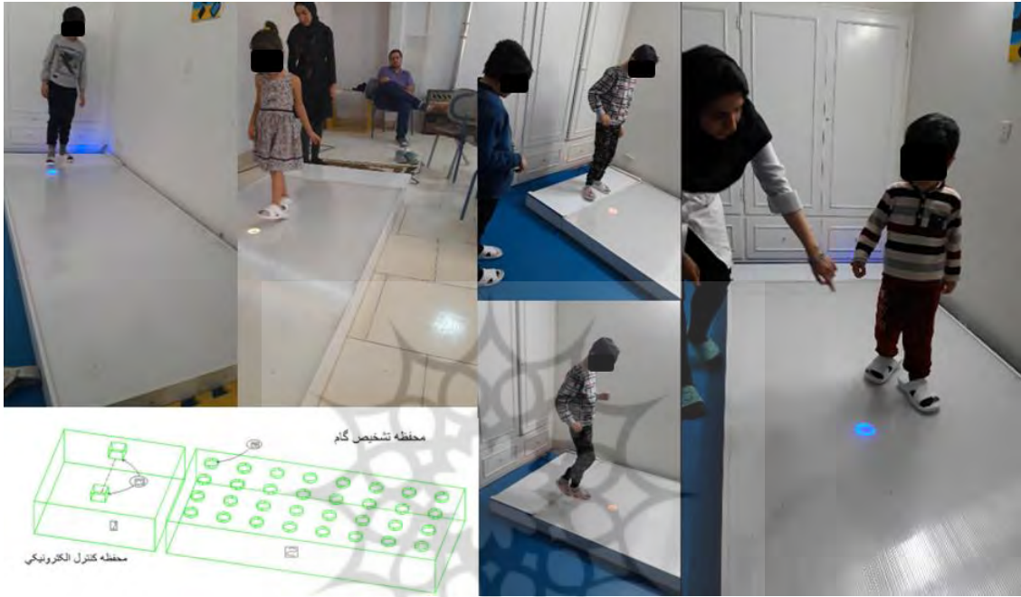
شکل ۱- جدول نوری گامبرداری Figure 1- Stepping light table
