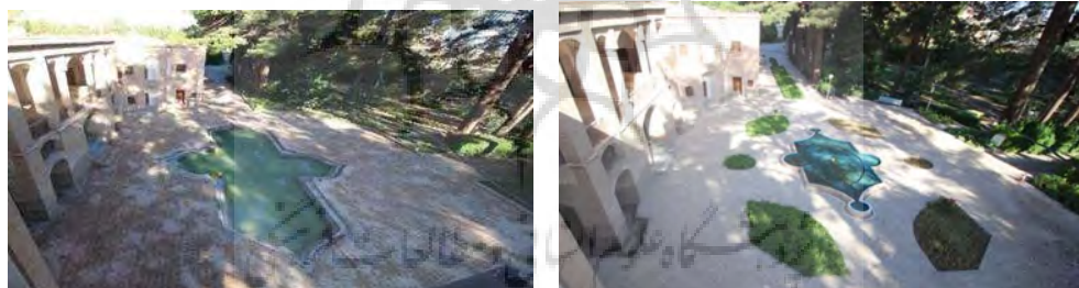
تصویر ۲۰. تغییر حوض که در ابتدا بزرگ و در داخل زمین بوده ولی بعد از ورود خودرو کوچک می‌شود و به‌صورت لبه‌دار بر روی کف ساخته می‌شود.
