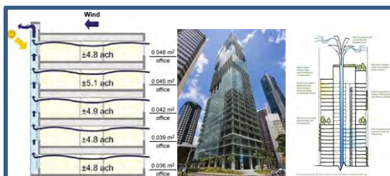
شکل ۱۹- سیستم تهویه طبیعی برج کپیتاگرین در سنگاپور
