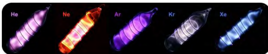
شکل ۴: لوله های تخلیه گاز پر شده از هلیوم، نئون، آرگون، کریپتون و زنون (MIT OpenCourseWare)
