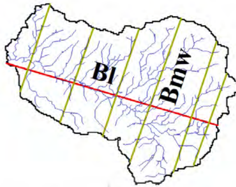
شکل ۲۶: تصویر شماتیک از روش محاسبه شاخص نسبت طول حوضه زهکشی به میانگین عرض آن (BI/Bmw)
