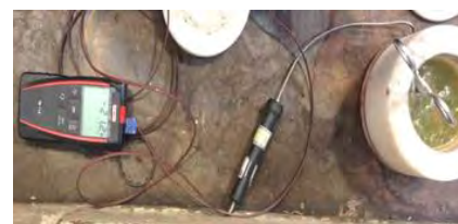
شکل ۷. کاهش دمای نمونه‌ها به ۲۰- درجه سانتی‌گراد برای آزمون ضربه شاری
