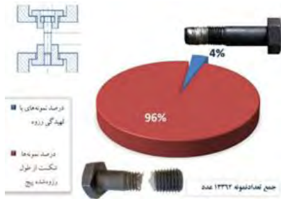
شکل ۱۷. درصد الگوی شکست در آزمایش کشش پیچ با ابزار ISO 898-1 (۲۰۱۳)
