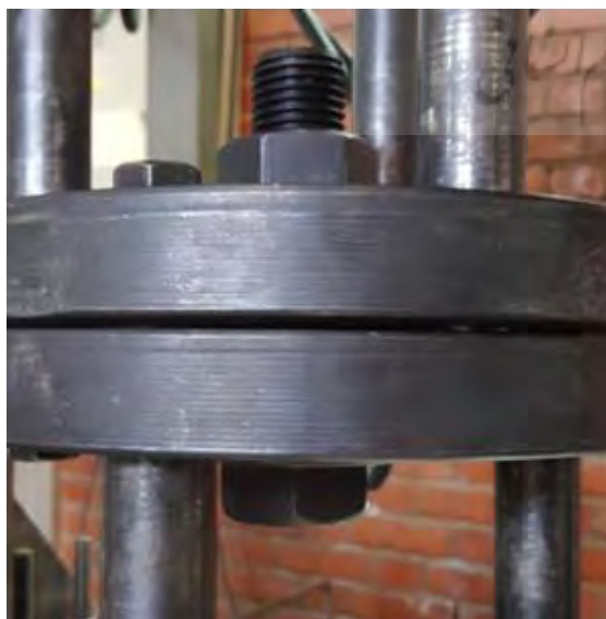
شکل ۱۴. انجام آزمایش کشش با پیچ با مهره
