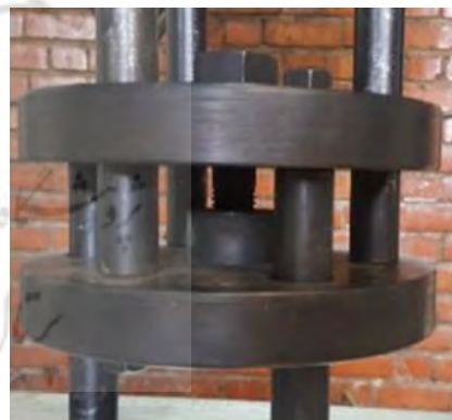
شکل ۱۱. انجام آزمایش کشش پیچ به روش ایزو
