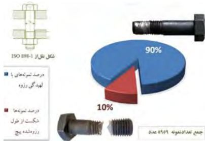
شکل ۱۸. درصد الگوی شکست در آزمایش کشش پیچ با مهره
