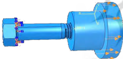
شکل ۲۴. شرایط تکیه‌گاهی و اعمال جابجایی پیچ آزمایش شده با ابزار استاندارد ISO 898-1 (۲۰۱۳)
