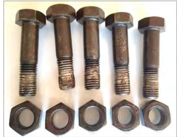
شکل ۱۵. حالات خرابی پنج نمونه پیچ شماره ۲۰ در آزمایش استحکام کششی با مهره
