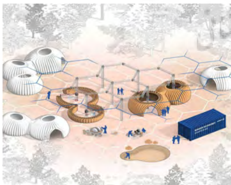
تصویر ۸. آرایش شش ضلعی پرینترهای شرکت وسپ. مأخذ: ( https://www.3dwaspp.com/en/3d-printed-house-tecla/ )
