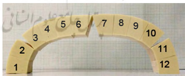
تصویر ۱۵: نحوه دیگر انتقال ترک‌ها در قوس شبدری کند با نسبت ضخامت به دهانه ۰/۲
