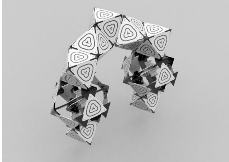
شکل ۶. حرکت مدول‌ها، در این سازه دو مفصل در دو پای مجموعه قرار گرفته و از بالا با مدول‌های غیرفعال به یکدیگر متصل شده‌اند، مأخذ نگارندگان
