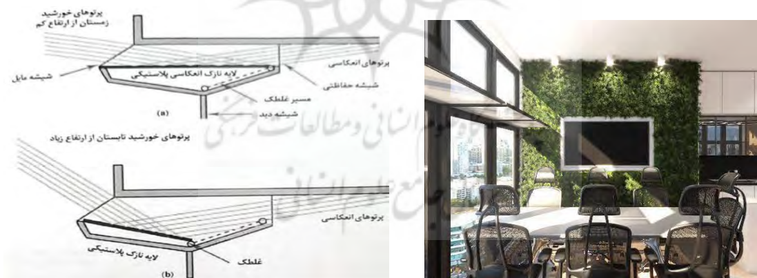
شکل ۵ سیستم رف نوری با مساحت متغیر و دو بخش مجزا یکی با زوایای خورشید کم و دیگری با زوایای خورشید زیاد
