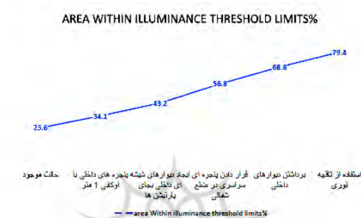
شکل ۱۰. تأثیر راهکارها در جهت افزایش روشنایی طبیعی ساختمان
