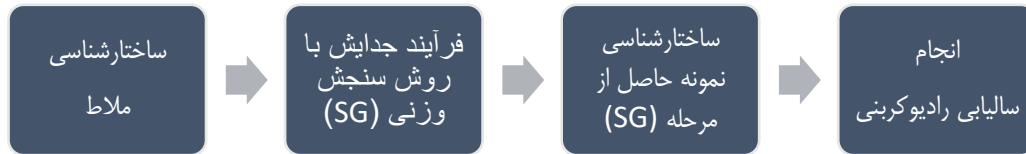
شکل ۵: مراحل انجام نسخه دوم از فرآیند جدایش بست آهکی ملاط به روش Cryo2sonic پیش از انجام سالیابی ^{14}\text{C} (Addis et al., 2019)
