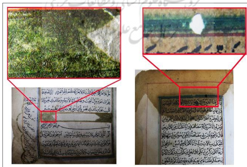
شکل ۶: خوردگی فلز تحت تأثیر لکه‌ی روغنی در نمونه‌های تاریخی (راست: نمونه‌ی C، چپ: نمونه‌ی B)
