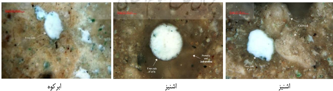
شکل ۱۲: وجود آهک‌های آزاد (آلوتک) ناشی از دیر شکستگی و گیرش ناقص اکسید کلسیم
