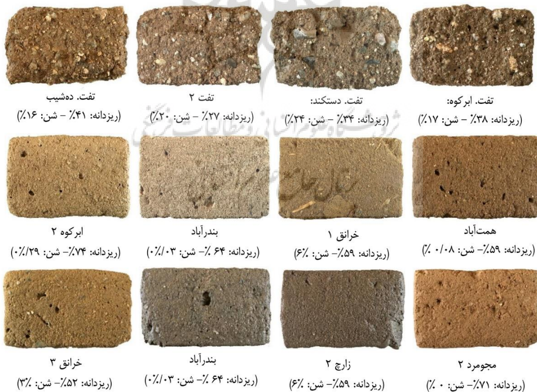
شکل ۶: بافت نمونه‌های خشت پس از آزمون جذب رطوبت
