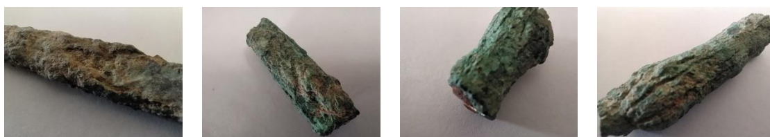
شکل ۳: رسوبات سطحی، خوردگی نمونه‌ها به رنگ سبز روشن، سبز تیره، آبی و قرمز قهوه‌ای در سطح اصلی
