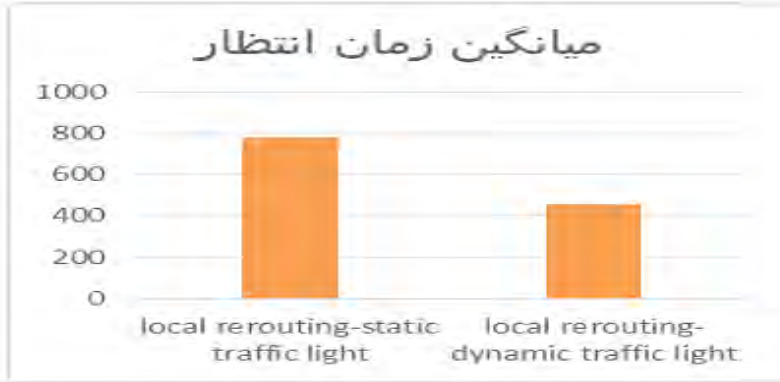
شکل ۵: مقایسه میانگین زمان انتظار برای حالت‌های چراغ راهنمایی ایستا و پویا.
