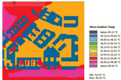
شکل ۱۶. نحوه توزیع دمای هوا در محدوده نمونه در روز اول تیرماه ساعت ۱۲ ظهر در ENVI-met
