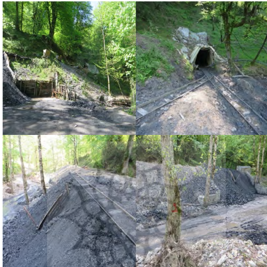
شکل ۶: تصاویری از ورودی معدن زغال سنگ، مسیر خروج مواد معدنی و محل تجمع باطله‌های معدنی
