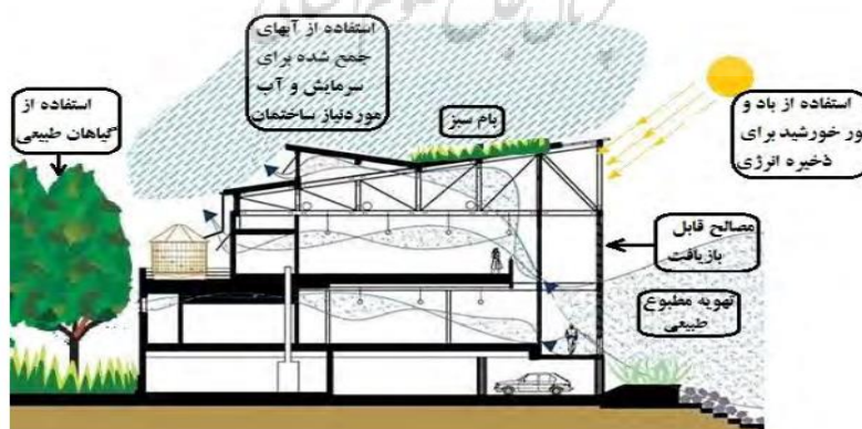
شکل ۱- نمونه‌ای از موارد قابل استفاده از کلیات معماری پایدار در طراحی‌های امروز
