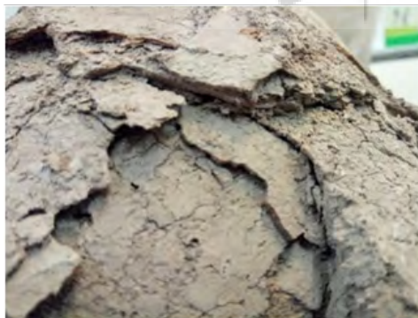
شکل ۱۰. از راست به چپ: لایه رسوبات تشکیل شده در سطح اثر. نفوذ رسوبات بین لایه‌ها و ایجاد آسیب بر اثر نوسانات محیطی.
