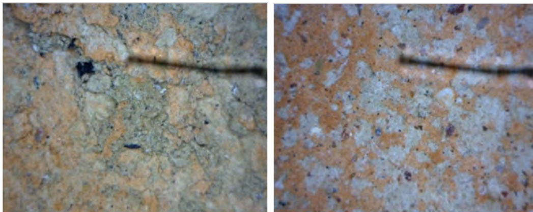
شکل ۱۴. از راست به چپ: رسوب نمک‌های محلول بر سطح سفال (بزرگنمایی ۵۰X). نفوذ نمک‌ها و آسیب‌های وارده بر اثر تبلور آن‌ها (بزرگنمایی ۵۰X).
