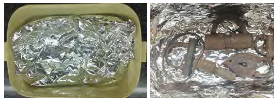
شکل ۱۰. آماده کردن محفظه آلومینیومی و غوطه‌وری آن‌ها در محلول برای برداشتن رسوبات و محصولات خوردگی
