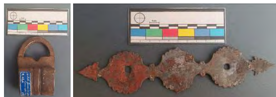
شکل ۷. نمایی از محصولات خوردگی اکسیدی
