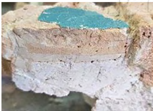
شکل ۷. تفاوت رنگ و بافت ملاط مرمتی استفاده شده.
