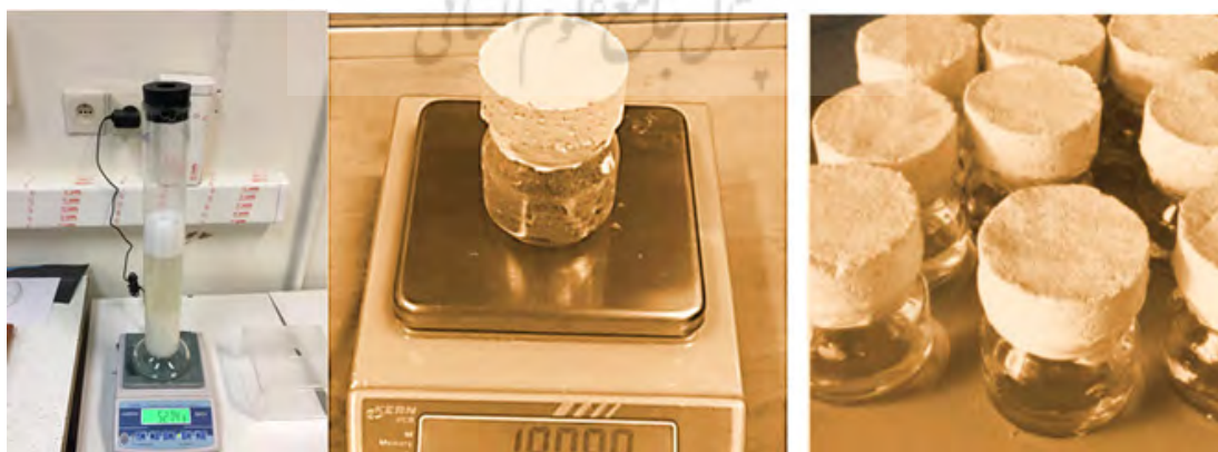
شکل ۱۳. ملات آهکی تحت تست نفوذپذیری بخار آب، تولید محلول اشباع نیترات پتاسیم در آزمایشگاه (تصویر چپ)
