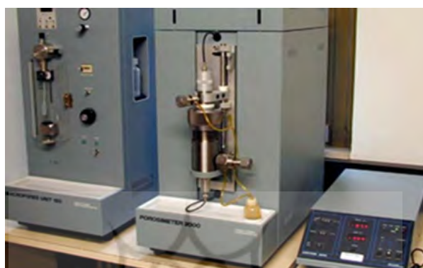
شکل ۸. دستگاه تخلخل سنج مورد استفاده Carlo Erba porosimeter
