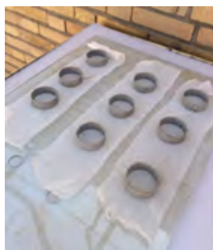
شکل ۴. نمونه‌های ملات‌های آهکی برای تست‌های مختلف در آزمایشگاه
