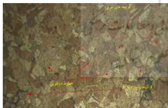
شکل ۶. ریزساختار پس از اچ ۲ ثانیه‌ای، شامل دانه‌های کار شده به همراه خطوط دوقلوبی شامل کار گرم و تاب کاری و خطوط کرنش نشان‌دهنده کار سرد دو تصویر بالا با بزرگنمایی ۲۰۰ برابر و دو تصویر پایین با بزرگنمایی ۴۰۰ برابر منبع: نگارنده
