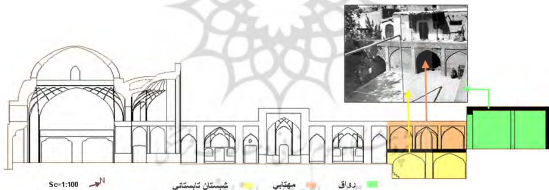
شکل ۳. شبستان تابستانه، مهتابی و رواق در مقطع طولی منبع: نقش عجب، تحلیل: نگارنده
