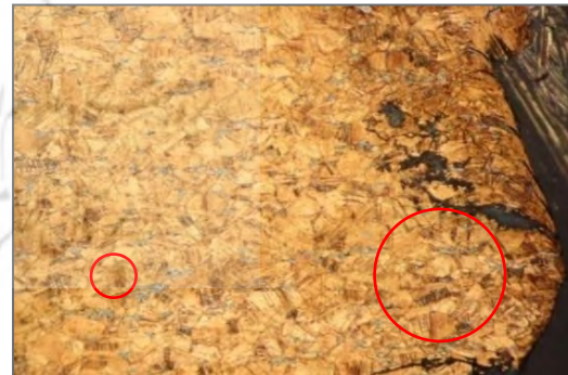
تصویر ۱۴. آخال‌ها و خطوط لغزش و دوقلوبی در تصویر نمونه یک با زمینه روشن و بزرگ‌نمایی ۲۰۰ برابر پس از اچ شدن زیر میکروسکوپ نوری (مأخذ: نگارنده).
