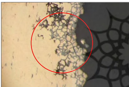
تصویر ۱۰. اچ شدن طبیعی قبل از اچ شدن شیمیایی و مرزهای دانه‌بندی نمونه با زمینه روشن و بزرگ‌نمایی ۱۰۰ برابر زیر میکروسکوپ نوری (مأخذ: نگارنده).
