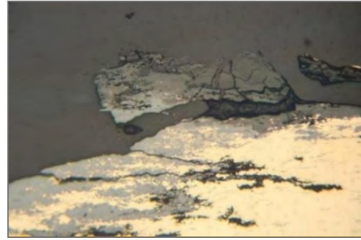
تصویر ۱۲. خوردگی‌های نمونه با زمینه روشن و بزرگ‌نمایی ۱۰۰ برابر قبل از اچ شدن زیر میکروسکوپ نوری (مأخذ: نگارنده).
