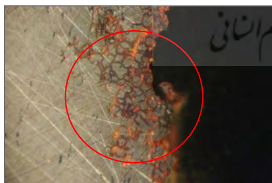
تصویر ۱۱. خوردگی‌های نمونه قبل از اچ شدن با زمینه تیره توسط فیتز پولاریزان و بزرگ‌نمایی ۱۰۰ برابر زیر میکروسکوپ نوری (مأخذ: نگارنده).
