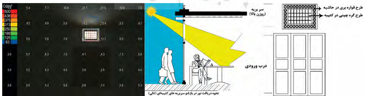
تصویر ۴: تحلیل اجزاء و نحوه عملکرد نورگیری بازشو سربرّیه‌های کتیبه‌ای (تکی) محله مسجدبر ماسوله (نگارندگان)
