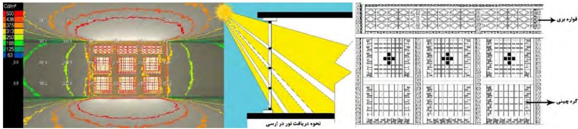
تصویر ۷: تحلیل اجزاء و نحوه عملکرد نورگیری ارسی محله مسجدر (نگارندگان)
